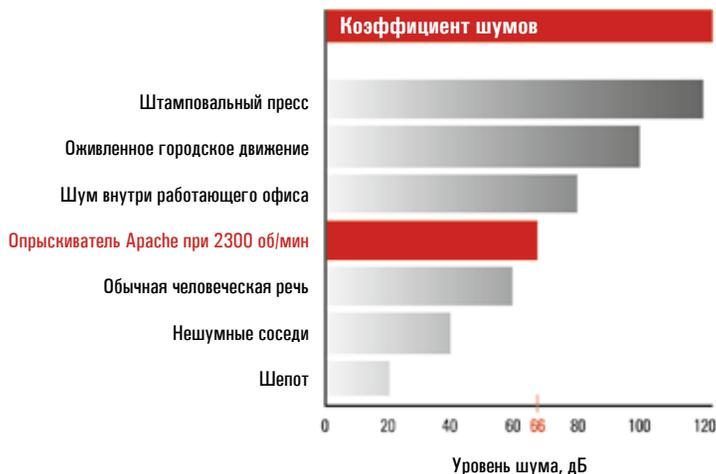
И без того тихий Arache стал **ЕЩЕ ТИШЕ** в 2016 модельном году. Модели AS1030 и AS1230 стали "тише" на 6 процентов, а модель AS730 – на 1 процент, чем соответствующие машины 2015 года. Уровень шума снижен за счет удаления кабины от двигателя и трансмиссии, использования совершенных звукоизоляционных материалов напольных ковриков и обивки и гофрированной выхлопной трубы, снижающей вибрацию и шум в кабине.
