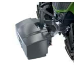
Передний силовой подъемник полностью интегрирован в машину.
