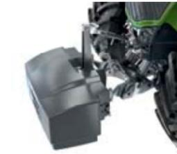
Передний противовес может быть легко снят и установлен даже без переднего силового подъемника.
