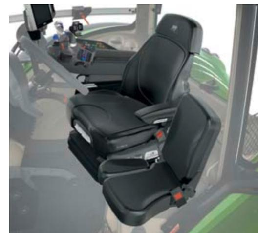
Комфортное сиденье переднего пассажира имеет эргономичную конструкцию и дополнительно снабжено мягкой обивкой. В сложенном состоянии это кресло выполняет роль стола.
