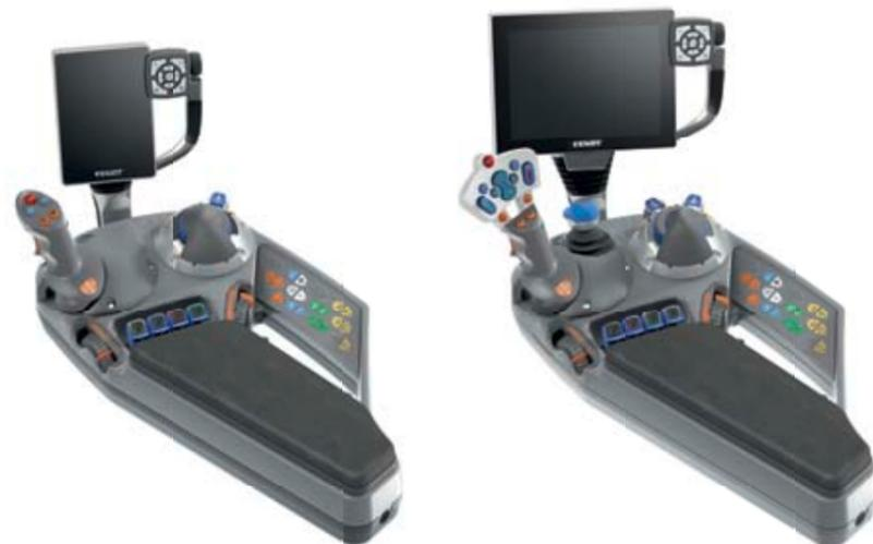
Мультифункциональный подлокотник в комплектации Power с Varioterminal 7-B; джойстик Power, кнопками круиз-контроля и предустановленных оборотов двигателя; органы управления навесками, MOM; Varioterminal 7-B с настоящей стеклянной поверхностью обладает интуитивной навигацией в меню, сенсорным и кнопочным управлением, а также системой управления рабочими орудиями, совместимыми с ISOBUS.
