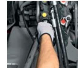
Муфты DCUP позволяют произвести соединение под давлением с двух сторон. Рычаг сброса давления позволяет легко осуществить соединение.
