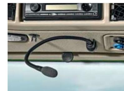
В Fendt 1000 Vario вы можете делать звонки отличного качества на громкой связи: гибкий удлиненный микрофон позволяет освободить руки и имеет отличную акустику.
