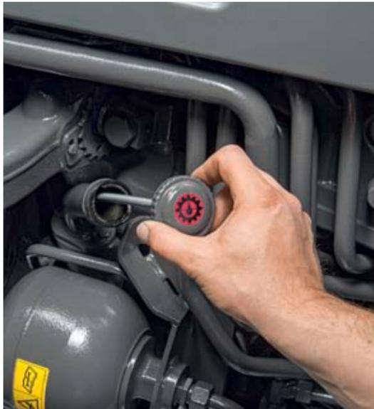
Работы по техническому обслуживанию, такие как проверка уровня масла или замена фильтра, выполняются на Fendt 1000 Vario легко и быстро. Благодаря съемному боковому элементу открывается прекрасный доступ к моторному отсеку.
