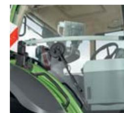
Стеклоочиститель бокового стекла с охватом в 220° даже при сложных условиях обеспечивает оптимальный обзор с правой стороны.
