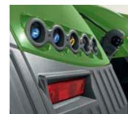
Органы управления гидрораспределителем, задней навеской, активацией заднего MOMа расположены на задних крыльях.
