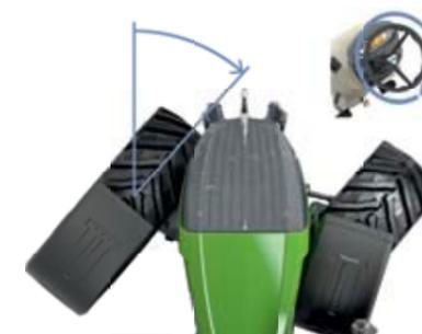
Благодаря VarioActive полный поворот колес выполняется уже после одного оборота рулевого колеса.
