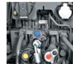
Самозакрывающиеся заслонки клапанов защищают от попадания загрязнений и позволяют выполнять соединение одной рукой.
