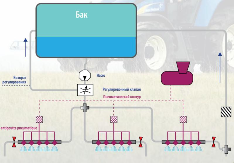
Она обеспечивает циркуляцию раствора как во время, так и вне цикла опрыскивания. Опираясь на использование пневматической системы защиты от подтекания (AGP) она приносит различные преимущества:
