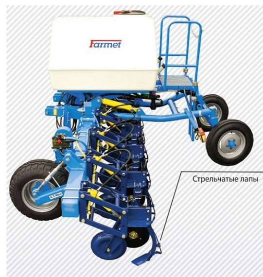
1. Стойка для рыхления и подрезания почвы.
