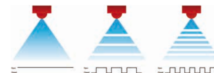
StrictSprayPlus розраховує швидкість перемикання форсунок та необхідну витрату розчину для кожної форсунки
