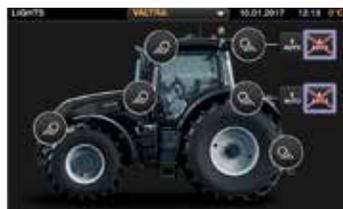
Простота настройки рабочего освещения через терминал. Переключатель включения / выключения рабочего освещения на подлокотнике, а так же выключатель включения / выключения маяка.
