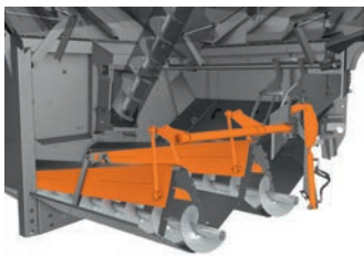
Закривні кришки над шнеками в підлозі зернового бункера управляють швидкістю розвантаження в п'яти положеннях.
