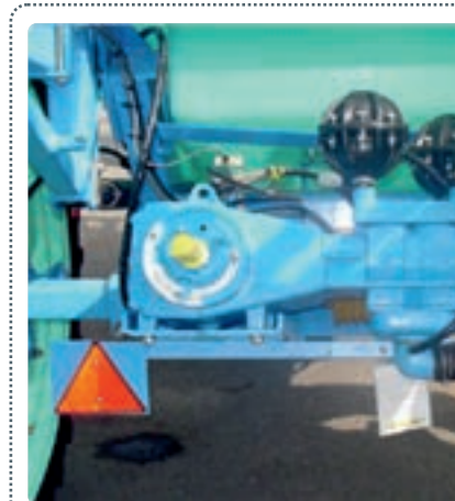
Система DPA. Привід насоса від колеса обприскувача
