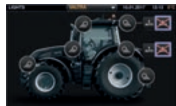
Просте налаштування робочого освітлення через термінал. Включення/відключення освітлення з підключника, а також керування проблисковим маячком.
